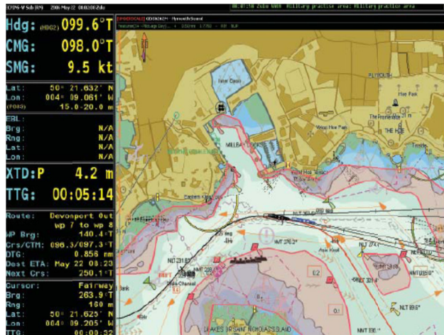
ΣΧΗΜΑ 18. Εικόνα Οθόνης Συστήματος ECPINS® W. Απεικονίζεται η χάραξη δρομολογίου και η επισήμανση των απαγορευμένων περιοχών λόγω βάρους ασφαλείας με χρήση γραμμών θέσεως ασφαλείας (Limiting Danger Lines) [12]
